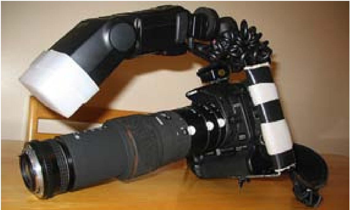
Abb. 5.5. Selbstgebautes Macro Rig mit Zwischenringen, Sigma 105 Macro und zusätzlicher Festbrennweite in Retrostellung als Vorsatzlinse. Der Blitz leuchtet genau den Raum direkt vor dem Objektiv aus. Abdruck mit freundlicher Genehmigung von Jon Law, www.improvedimage.co.uk .
